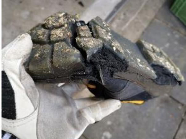
Sicherheitsschuhe müssen regelmäßig kontrolliert werden. Falsche oder zu lange Lagerung können dem Material schaden. Foto: VTH/Kollaxo
