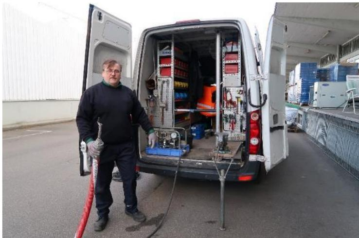
Mit modernen Prüffahrzeugen führen zertifizierte Technische Händler die Wiederholprüfungen direkt vor Ort durch und verwalten die dabei ermittelten technischen Daten im Rahmen eines Schlauchleitungs-Managementsystems. Foto: Rala
