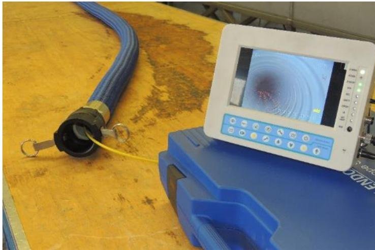
Wie sieht die Schlauchleitung von innen aus? Die Endoskopie zeigt, ob Beschädigungen an der Schlauchseele entstanden sind – beispielsweise durch aggressive Chemikalien oder zu hohe Temperaturen beim Reinigungsvorgang. Foto: Rala
