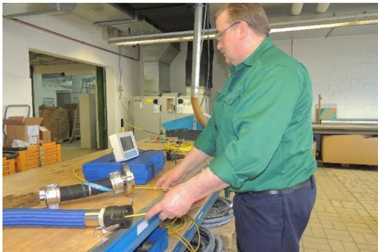
Die Qualität des Schlauchverbundes an sich, der Einbindung mit den Armaturen und der Schlauchseele ist visuell nur schwer zu ermitteln. Nur durch eine Festigkeitsprüfung mit dem vorgeschriebenem Prüfdruck, einer Leitfähigkeitsprüfung und einer fachkundigen Begutachtung kann sichergestellt werden, dass die Schlauchleitung weiterhin sicher betrieben werden kann. Foto: Rala
